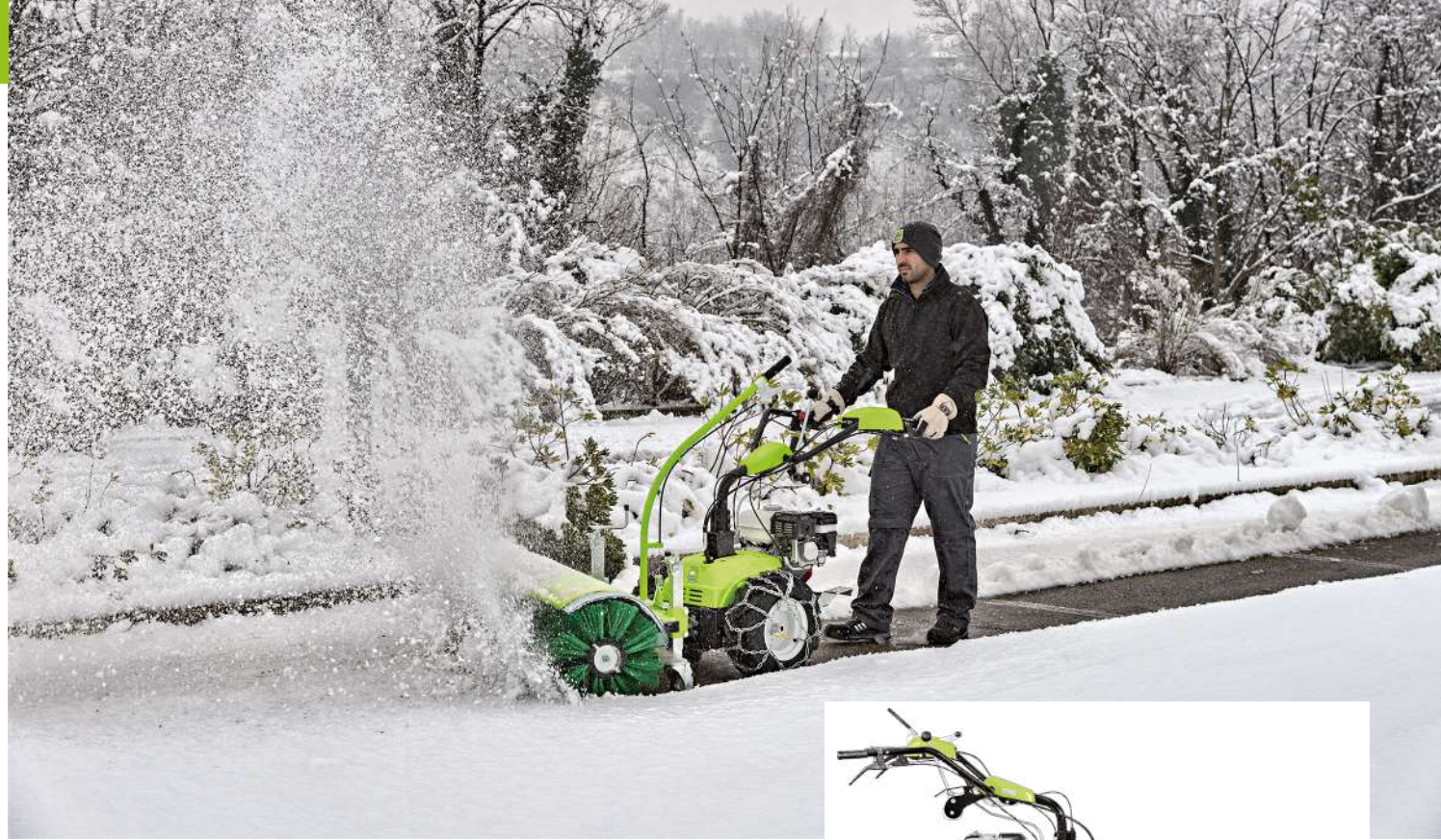
Der Lenkholm kann sowohl in der Höhe eingestellt werden, um den Anforderungen aller Nutzer gerecht zu werden, als auch seitlich zur Begünstigung der Arbeiten an schwierigen Stellen wie z.B. unter niedrigen Zweigen oder bei Hindernissen.
