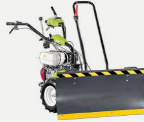
Version mit schwenkbarem Schneeschild 100 cm für GH 7- GH 9
