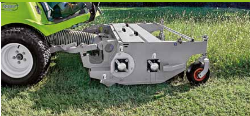
Modalidad de corte con descarga
